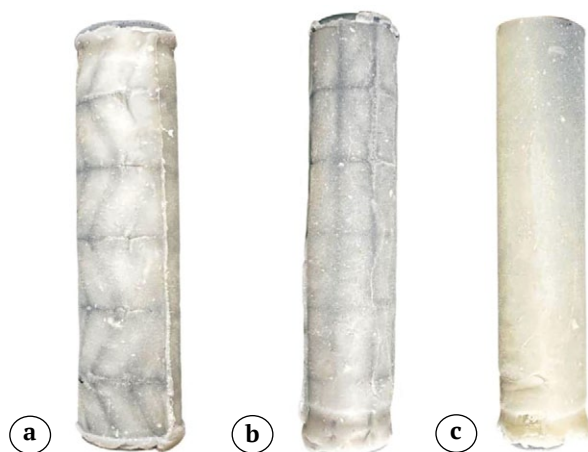
Рис. 2. Итоговый вид изготовленных образцов: а — образец структуры V2; б — образец структуры V3 ; с — контрольный образец структуры C
