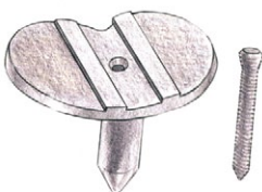
Рис. 7. Центральный тип фиксации пластикового вкладыша в большеберцовом компоненте эндопротеза коленного сустава
