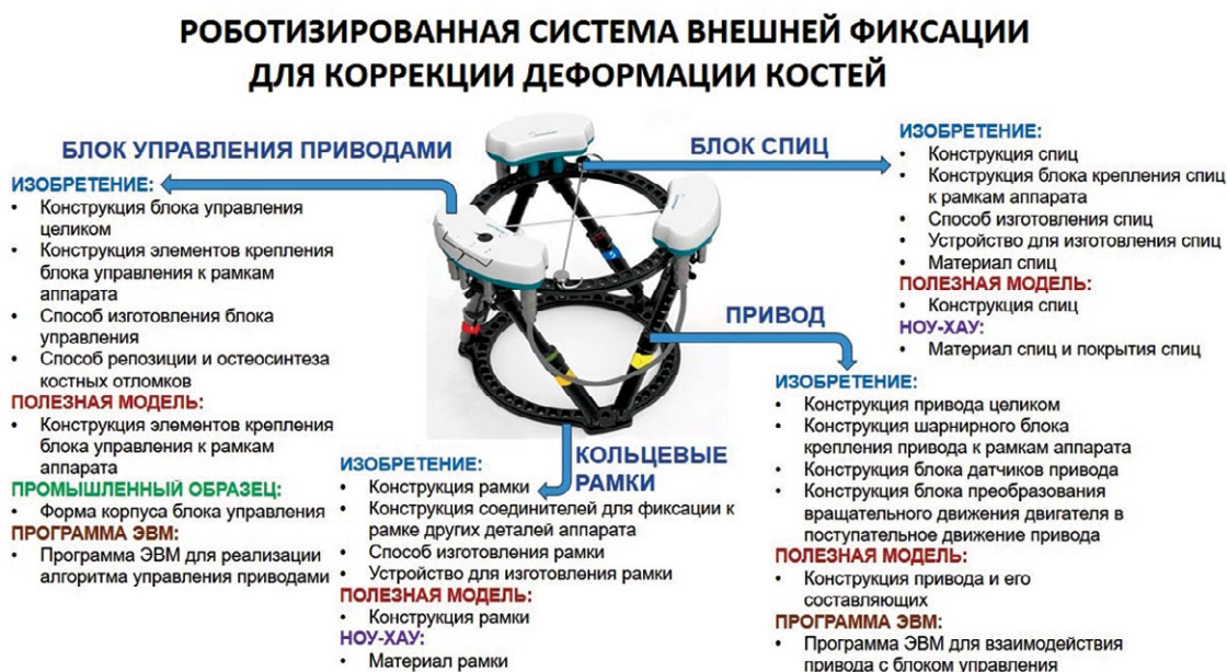
Рис. 4. Варианты объектов, на которые можно получить правовую охрану, на примере роботизированной системы внешней фиксации для коррекции деформации костей [6]
