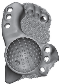
Рис. 2. Компьютерная 3D-модель индивидуального трехфланцевого компонента эндопротеза пациентки А., состоящий из полусферы, трех фланцев и пористого слоя
