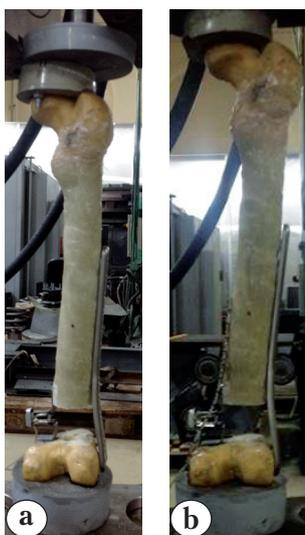
**Рис. 2.** Установка моделей переломов в испытательной машине: а – первая серия с латеральной фиксацией; б – вторая серия с двусторонней (латеральной и медиальной) фиксацией
