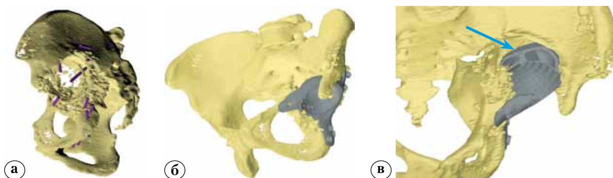
Рис. 4. Этапы проектирования имплантата: а – моделирование направлений каналов винтов; б, в – общий вид имплантата (стрелкой указан аугмент, упирающийся в верхнюю границу дефекта)
