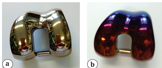
Рис. 1. Вид имплантатов: а — без покрытия; б — с покрытием ДУ ЛЦУ+Ag
