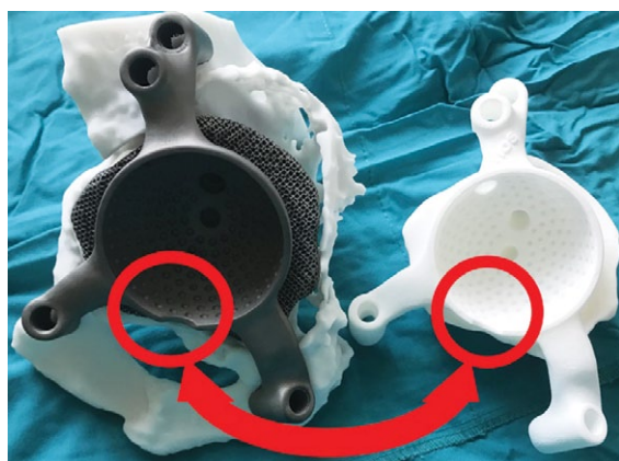
Рис. 3. Индивидуально изготовленные фрагмент таза, компонент и примерочная модель вертлужной впадины. Дополнительная выемка на «6 часах» для ориентирования при позиционировании имплантата в ране
