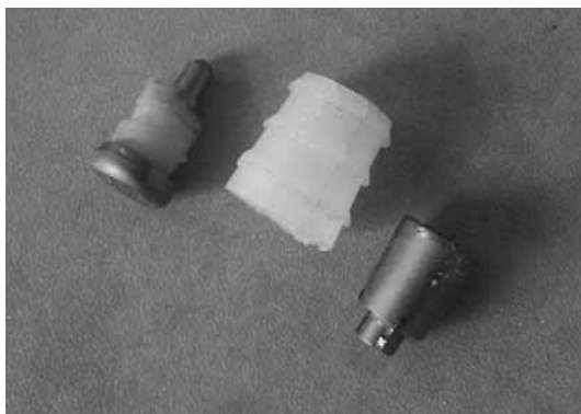
Рис. 13. Разрушение подтаранного имплантата «Kalix II» на составные части
