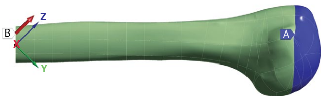
Рисунок 2. Схема нагружения проксимального отдела плечевой кости при имитации падения на руку: А — область закрепления кости в суставе; В — вектор силы
