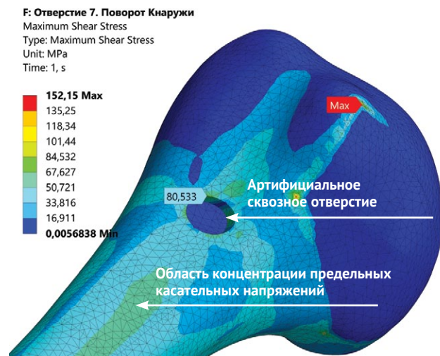
Рисунок 15. Касательные напряжения в кортикальной кости с отверстием d = 7,0/2,4 мм при ротации кнаружи Figure 15. Tangential stresses in the cortical bone with a hole d = 7.0/2.4 mm during external rotation
