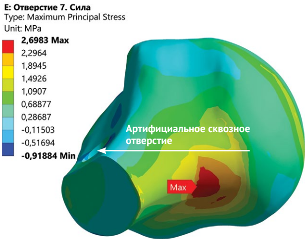
Рисунок 12. Максимальные главные растягивающие напряжения в трабекулярной кости с артифициальным сквозным отверстием d = 7,0/2,4 мм равны 2,6983 МПа
