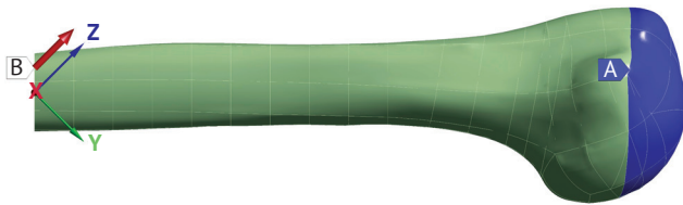
Рисунок 2. Схема нагружения проксимального отдела плечевой кости при имитации падения на руку:
