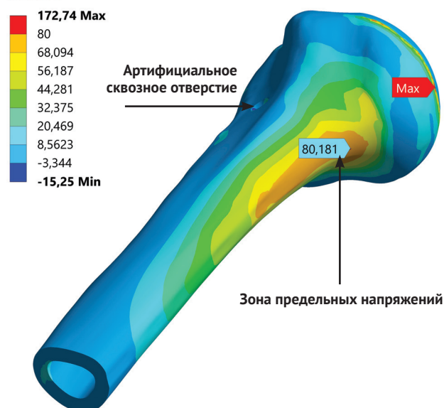
Рисунок 8. Главные растягивающие напряжения в кортикальной кости с отверстием d = 5,0/1,5 мм. Отверстие находится в зоне сжатия -3,344 МПа, вне зоны предельного растягивающего напряжения -80,181 МПа
