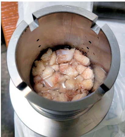
Рис. 2. Образец № 4 в цилиндре с отверстиями и добавлением водного раствора глицерина, моделирующего кровь в эксперименте
