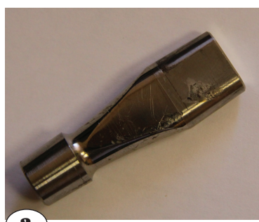
Рис. 4. Удаленный модульный бедренный компонент с признаками коррозии, пара титан-титан: а – модульная титановая шейка; б – модульный бедренный компонент
