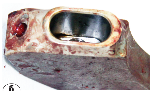
Рис. 4. Удаленный модульный бедренный компонент с признаками коррозии, пара титан-титан: а – модульная титановая шейка; б – модульный бедренный компонент
